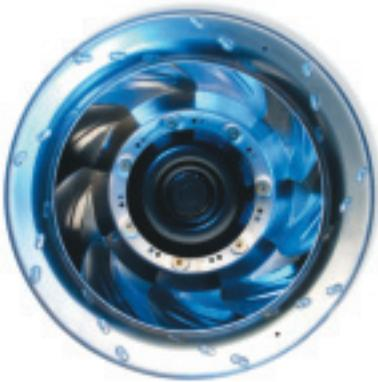
Преимущество EC-вентиляторов в низком энергопотреблении и простоте управления. Встроенная электронная система управления может изменять скорость вращения вентилятора для точного соответствия требованиям по расходу воздуха и работать с высоким уровнем эффективности. Для одинаковых расходов воздуха EC-вентиляторы потребляют существенно меньшее количество энергии, чем вентиляторы с АС двигателями.
